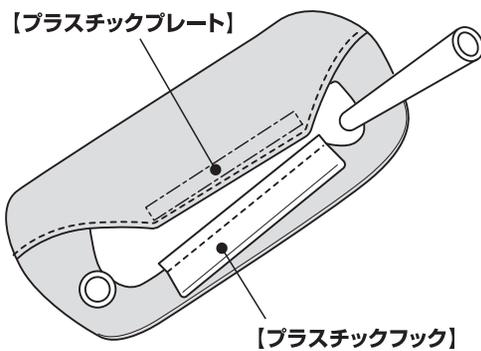
ヘッドレストをシート本体から取り外して底面の形を整えます。
