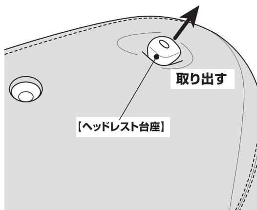
ヘッドレストの台座部分を穴から取り出します。生地伸びを利用して横から潜り込ませるように取り出してください。
