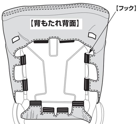
30系アルファード・ヴェルファイアで背面にバックパネルが装備されている場合、バックパネルを外し、カバーに設けているフックをシートに引っ掛けて固定します。
