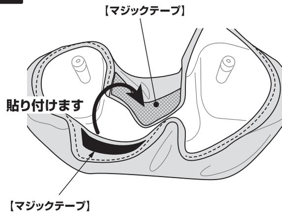
ヘッドレストを取り外し、マジックテープを固定して取付完了です。
