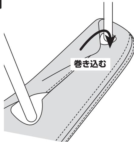
プラスチックプレートの付いた部分を内側に巻き込むように折り返してフック状のプラスチックの溝を押し込んでいきます。
