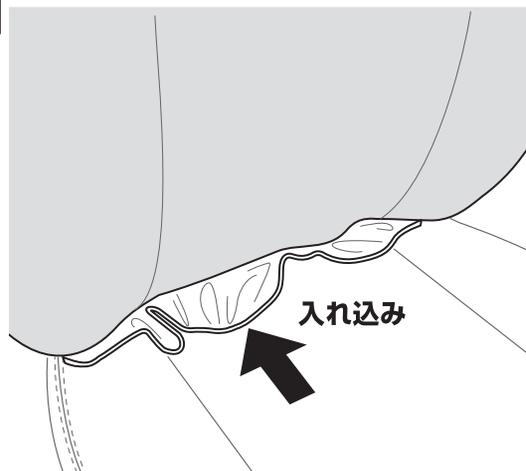
マジックテープ部分を座面と背もたれの間に入れ込んで背面に抜き出してください。
