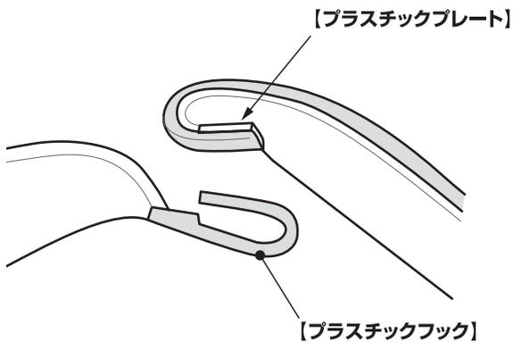
プラスチックプレート部分を上図のように内側に折り返します。
